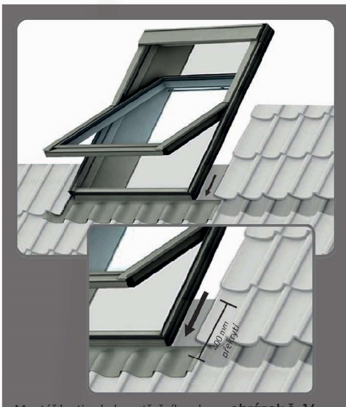
Montáž krytiny kolem střešního okna – obrázek č. 16
